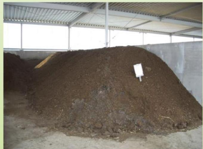
● 圖二. 禽畜糞堆肥，將禽畜糞收集完成添加部分有機調整材並補足水份後堆置，約45-60天可完全腐熟，其間需翻堆數次並適時補充水份，物理乾燥法之後續處理與生物法一般均為此流程。
