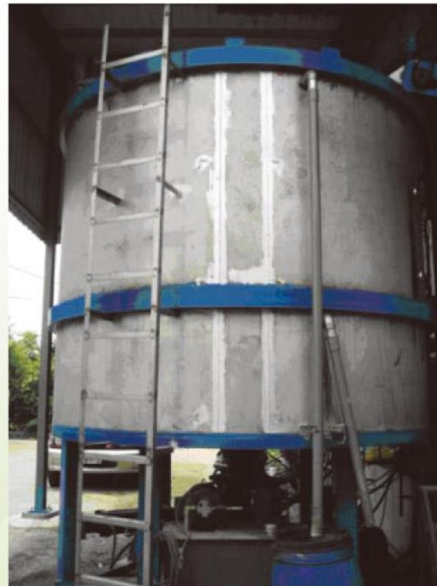
● 圖一. 簡易厭氧雞糞發酵槽（5噸槽，主槽體含攪拌器、加菌設備、甲烷收集槽...等）。
